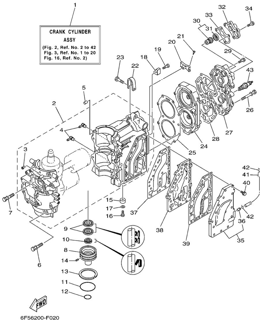
**FIG. 2 CYLINDER & CRANKCASE**
